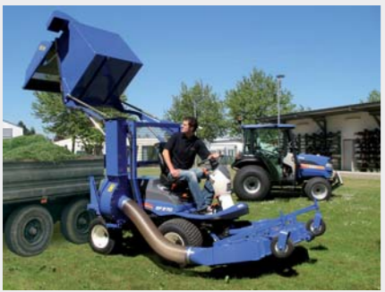
Hydraulické vyklápění do výšky 2,20 m a s přesahem 0,5 m je přesvědčivé.
