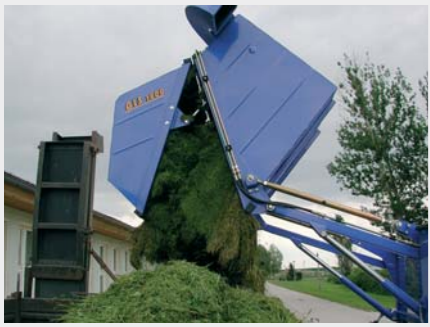
Sběrný kontejner je naplněn cca. na 100%*. Vysoký výkon turbíny sbíraný materiál dále stlačuje.
